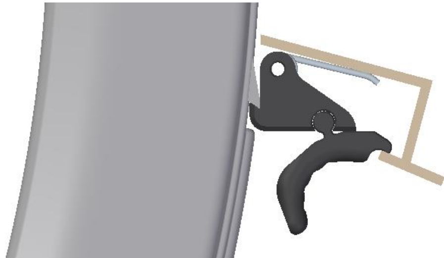
Abbildung 3: EINBAU IM SCHAFT - richtige Positionierung
